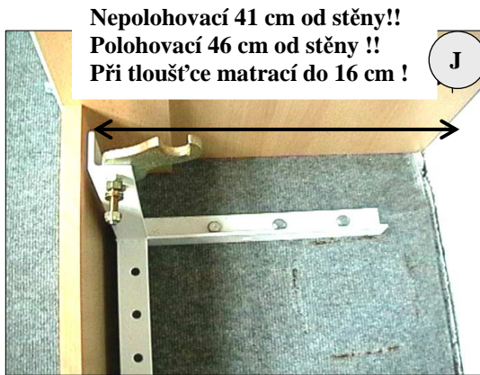
STANDARDNÍ KOTVENÍ DO PODLAHY
